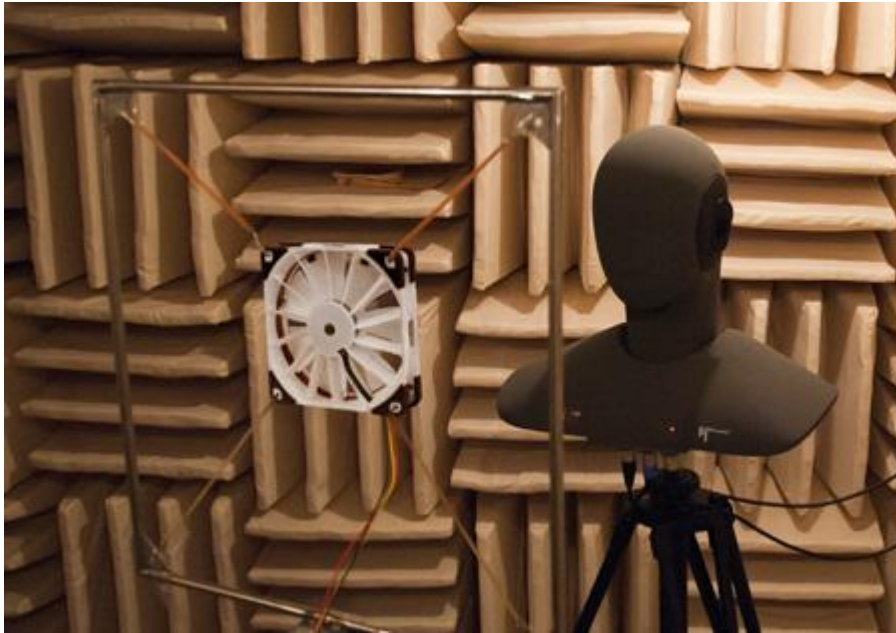
En prototyp av fläkten Noctua NF-F12 utrustad med RotoSubs ANC-teknik under provning i en ekofri kammare.
